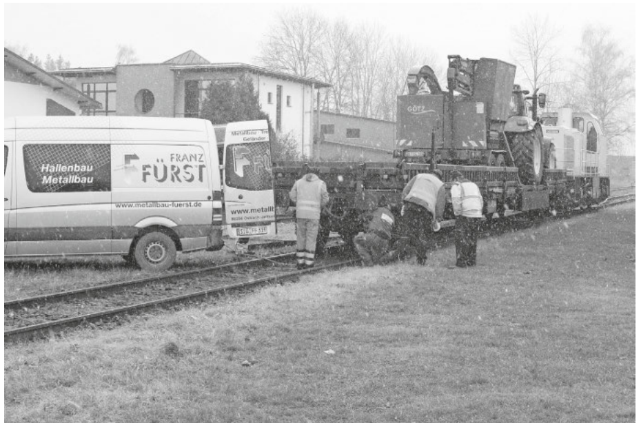
mit Unterstützung durch Ostracher Betriebe wird am Bahnhof Ostrach der Zug für die Arbeiten auf der Pfullendorfer Strecke vorbereitet. Zusätzlich zum Häcksler wurde ein Grüngut-Container geladen, so daß auch der gesamte Rückschnitt mit dem Zug abgefahren wird.
