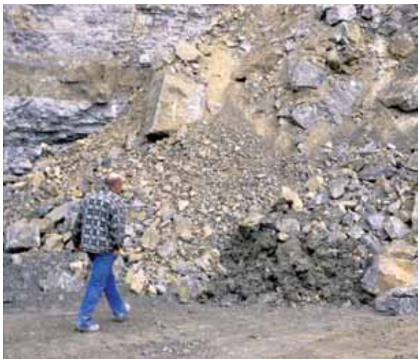
BILD 36: Bei der Anlage in Crailsheim wurde für Trockenbiotope zwischen den Kollektoren und im Traufbereich Muschelkalk-Haufwerk, Schroppen und Vorsieb aus einem örtlichen Steinbruch verwendet.
