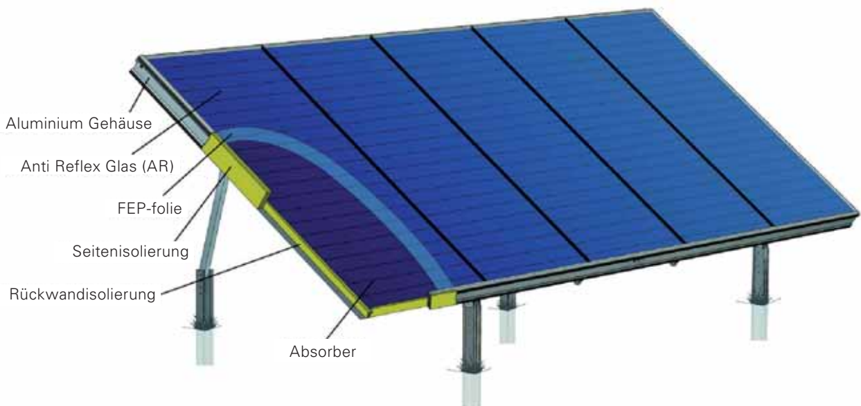
BILD 15: Aufbau eines HT-Flachkollektors.
